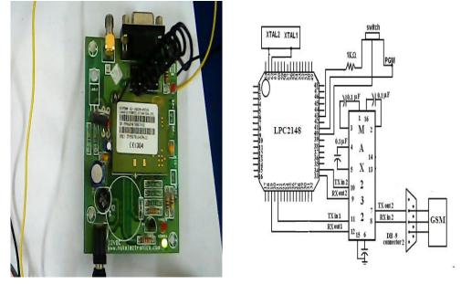
Fig5. SIM900 GSM MODULE
